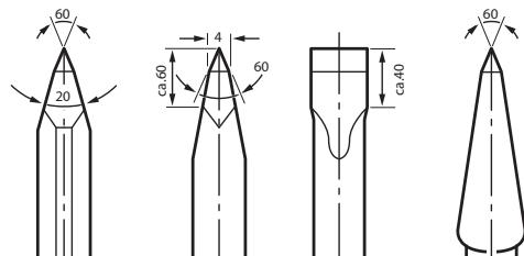
Для **ковки** нагревайте долбяжный инструмент до температуры от 850 до 1050 °C (от светло-красного до желтого).
